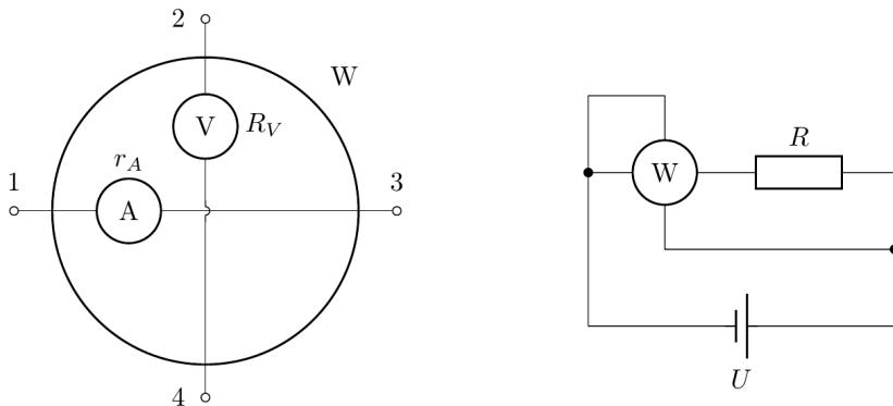
Глюк, решив во всём разобраться, собрал цепь, схема которой изображена на рисунке справа. В цепь он включил идеальный источник постоянного напряжения и резистор сопротивлением  $R = 500 \text{ Ом}$ . Ваттметр, подключённый к цепи, показал значение  $P_1 = 100 \text{ Вт}$ . Затем Глюк вытащил ваттметр из цепи, повернул его на  $90^\circ$  и снова вставил в цепь. После этого прибор показал значение  $P_2 = 1,0 \text{ Вт}$ . Изображение ваттметра на обеих схемах соответствует его внешнему виду.
