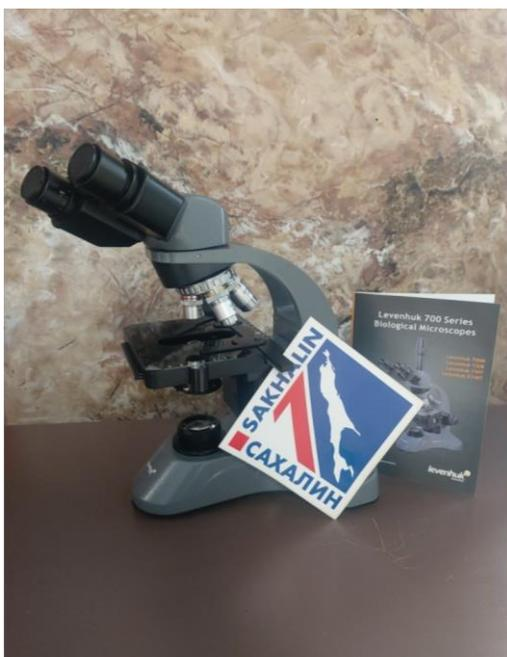
Биологический микроскоп с бинокулярной насадкой позволяет проводить исследования в проходящем свете по методу светлого поля. Объект исследований – прозрачные образцы и микропрепараты. Микроскоп имеет широкий диапазон кратности от 40х до 2000х, внутри которого можно выбрать несколько фиксированных увеличений. Практические занятия по биологии в период проведения летней интенсивной образовательной (профильной) смены проводились с использованием микроскопов.
